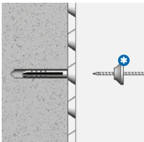
Fixation (env. 9 fixations/m<sup>2</sup> en application verticale) avec une cheville à frapper inox dans le creux de la nappe.
